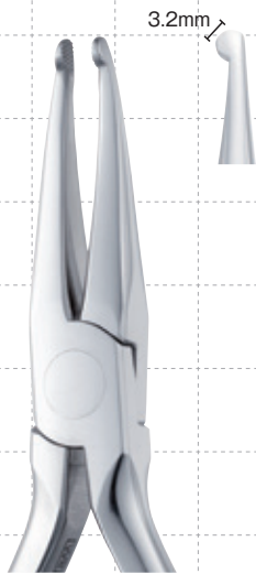
▲ 60-306T ハウ プライヤー HOW PLIER CODE NO.63061 全長：約 138mm Tips are 1/8"(3.2mm) diameter. 医療機器届出番号 09B2X00010000112 一般医療機器・歯科矯正用プライヤ
