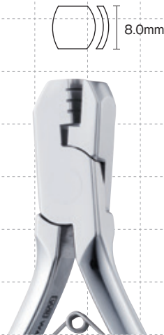
▲ 60-223TG アーチ フォーミング プライヤー - ミゾ付き ARCH FORMING PLIER-GROOVED CODE NO.62232 全長：約 116mm Grooves of .016", .018" and .022" 医療機器届出番号 09B2X00010000134 一般医療機器・歯科矯正用プライヤー
