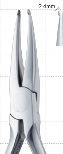
▲ 60-307 ハウ プライヤー - スモール HOW PLIER-SMALL CODE NO.63070 全長：約 138mm Tips are 3/32"(2.4mm) diameter. 医療機器届出番号 09B2X00010000112 一般医療機器・歯科矯正用プライヤ
